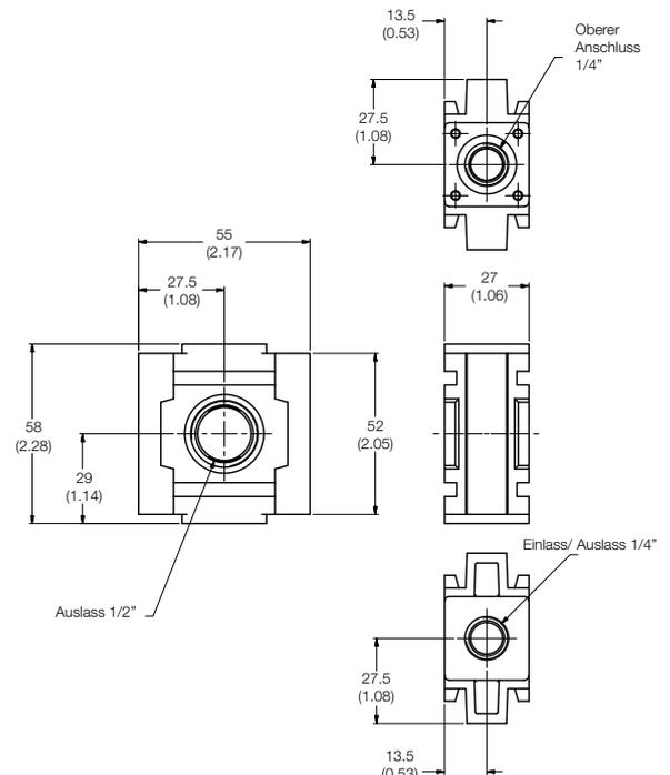
Verteilerblöcke - Abmessungen
