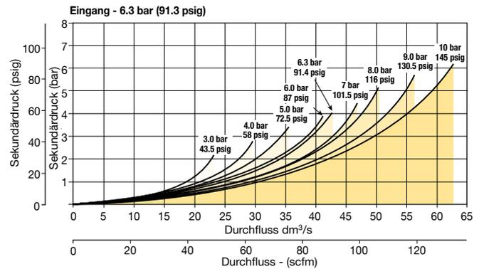
**P32TA 1/2" Druckaufbau und Abschaltventil**
