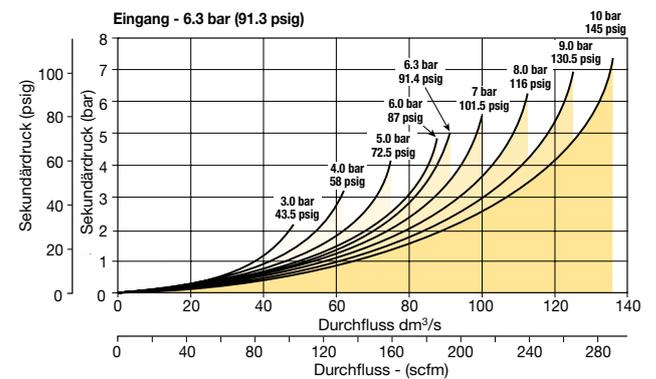
**Kombiniertes Druckaufbau-/ Schnellabschaltventil und ferngesteuertes Abschaltventil**
