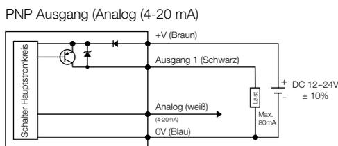
**Sensor-Pinbelegung mit analogem Ausgang**
